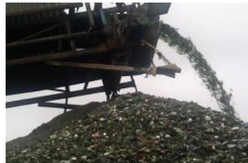
Figure 4 : manutention de calcin ménager
