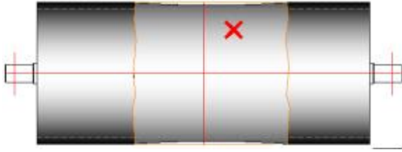
Figure 6.2 : profil concave par usure (instabilité bande)
